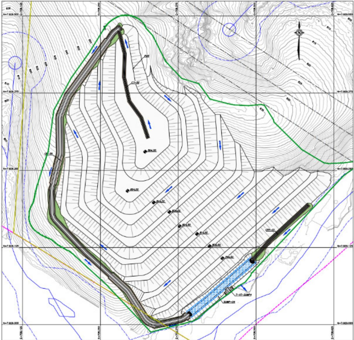
**Figura 38:** Arranjo do Sistema de Drenagem Superficial Projetado – PDR01.
