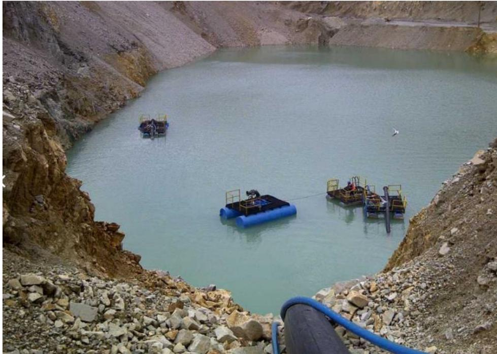
Figura 67: Imagem típica de sistema de captação em balsa instalado em fundo de mina.
