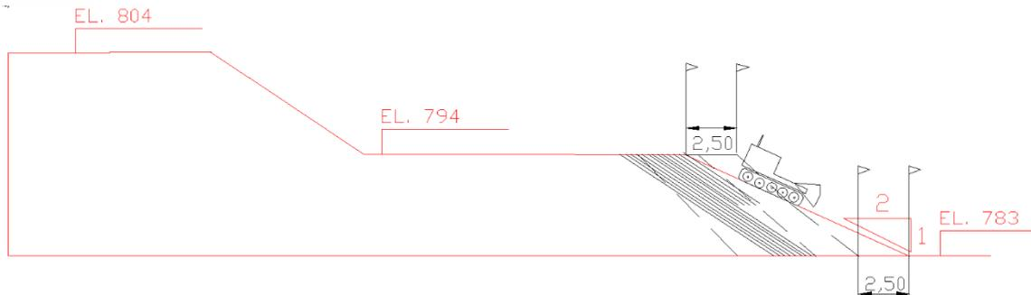
**Figura 93:** Formação do banco El. 794 m com inclinação da face 1V:2H.
