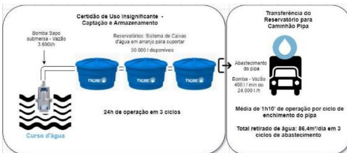
**Figura 100:** Esquema de captação e armazenamento de água.
